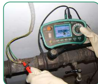
Sprawdzanie połączeń wyrównawczych
